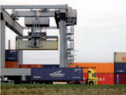
Askıdaki yükler, motor ve enkoder geri beslemesi sayesinde hassas şekilde pozisyonlanabilir.
